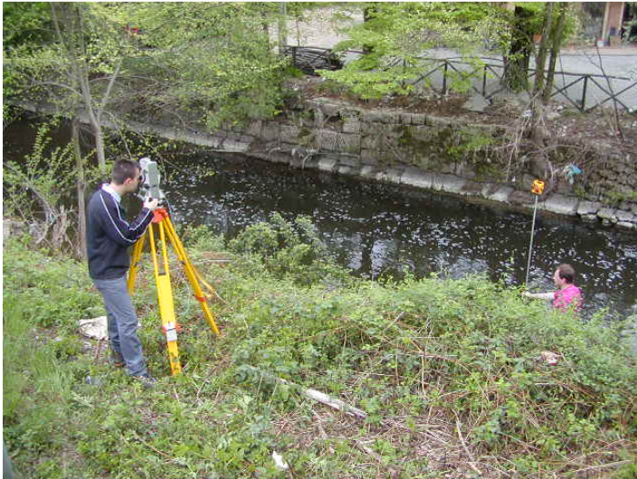
Foto 1: Rilievo topografico sezione A
